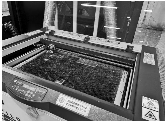
CO<sub>2</sub>レーザー加工機です。5mm のアクリル板を切り抜くことができます。
