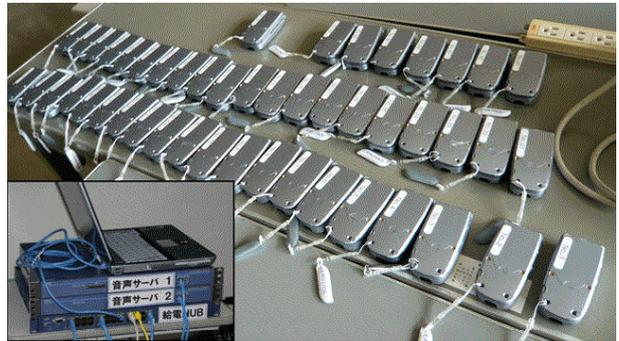
図2.2 携帯電話(NEC製 N900iL)及びSIPサーバ
