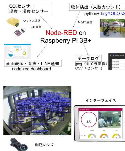
図1 開発したシステムと稼働時の様子
